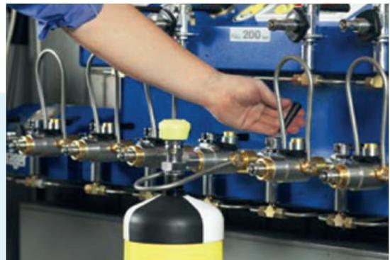
**UNSERE ATEMLUFTADAPTER WURDEN SPEZIELL ZUR SCHNELLEN ABFÜLLUNG VON ATEMLUFTFLASCHEN ENTWICKELT.**
